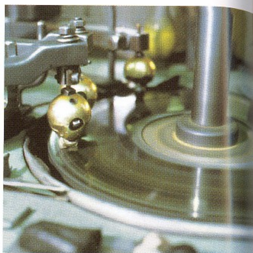
Огранка алмаза на горизонтально вращающемся шлифовальном круге с помощью клещевого захвата, направляющей гильзы
