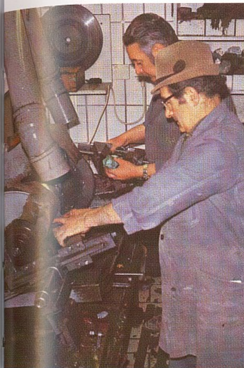
Резка агата алмазной фрезой
