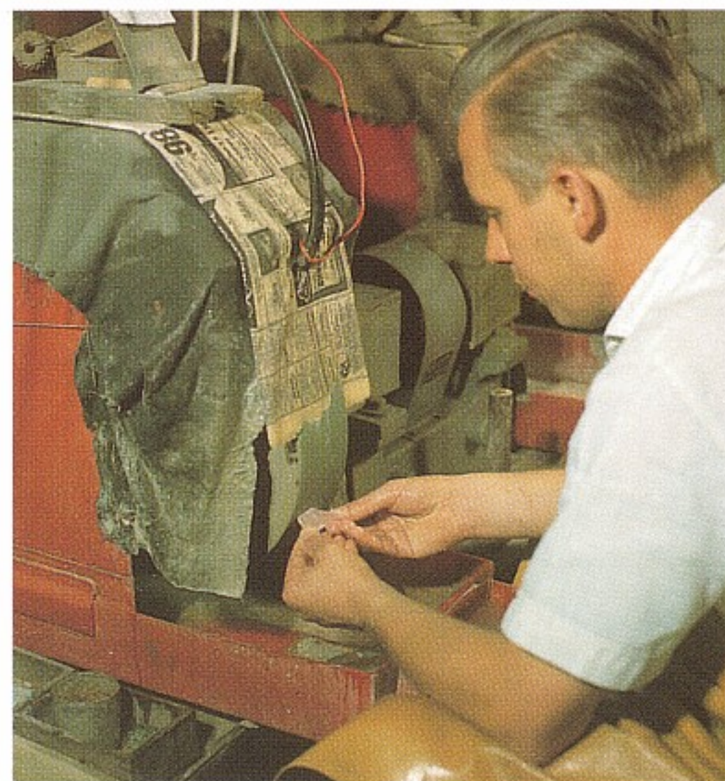
Предварительная огранка на вертикально вращающемся, слегка увлажненном круге из карборунда
