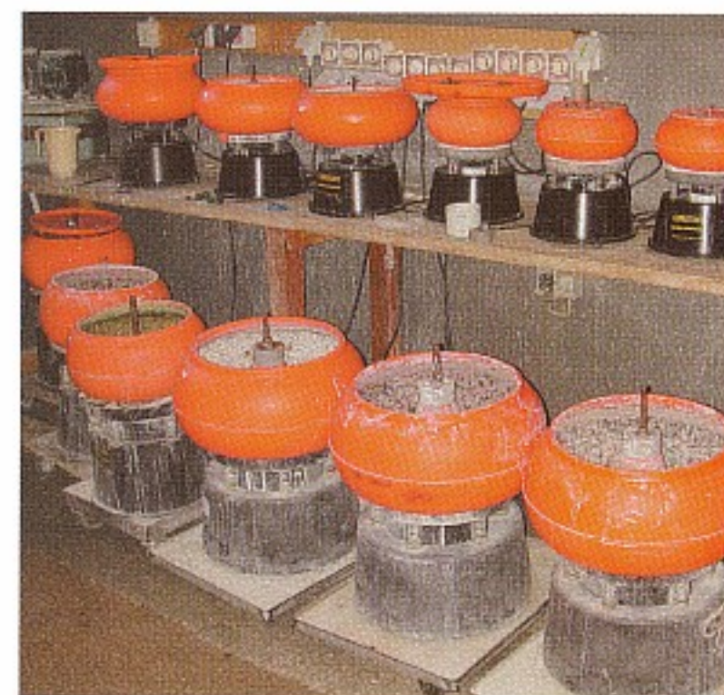
Установки для барабанной шлифовки, слева – со стальными барабанами с горизонтальной осью, справа – с вибрирующими барабанами и вертикальной осью
