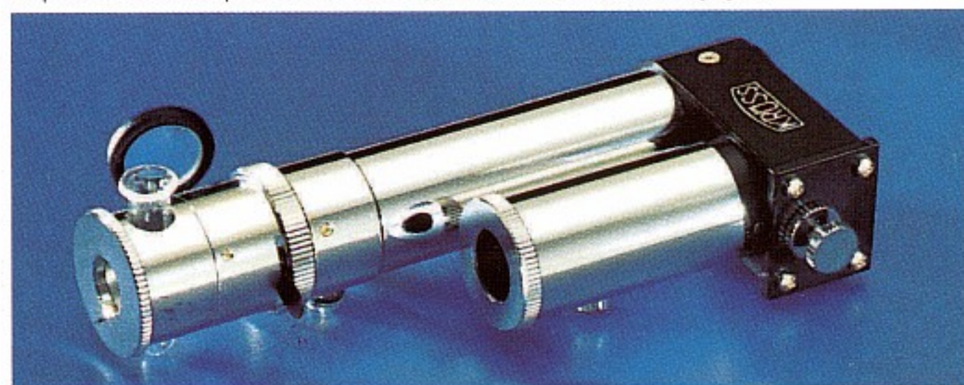
Портативный спектроскоп со шкалой длин волн в маленьком тубусе
