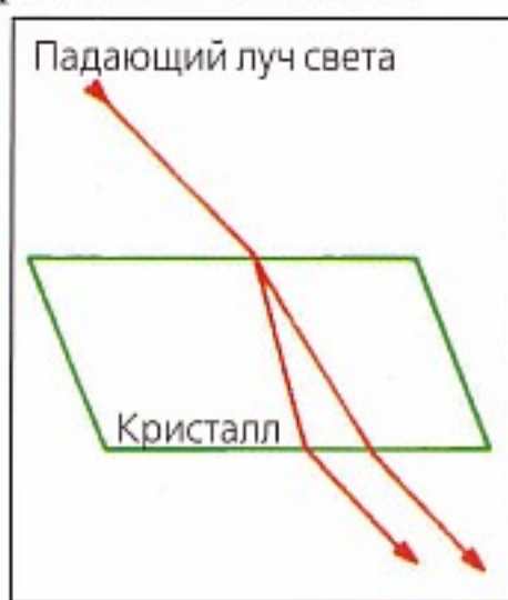
Отчетливое двойное преломление кальцита (слева) и схема двойного преломления (справа)
