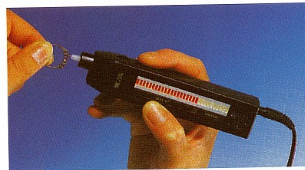
Тестер теплового сопротивления для диагностики имитаций алмаза
