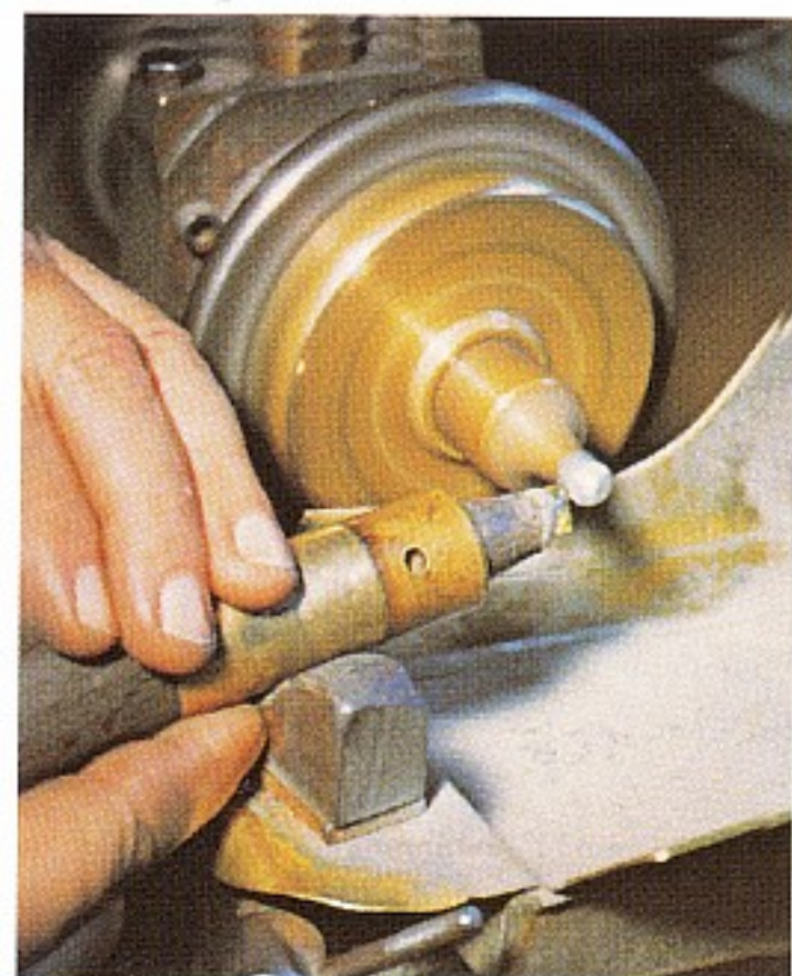
Путем трения двух алмазов друг о друга они оба получают форму заготовок для огранки бриллианта
