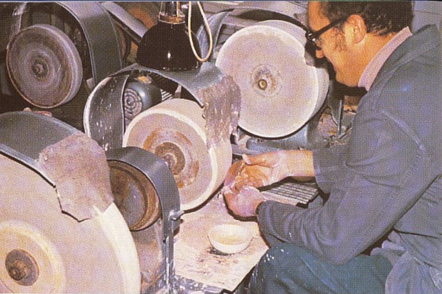
Полировка агата без применения или с небольшим количеством воды
