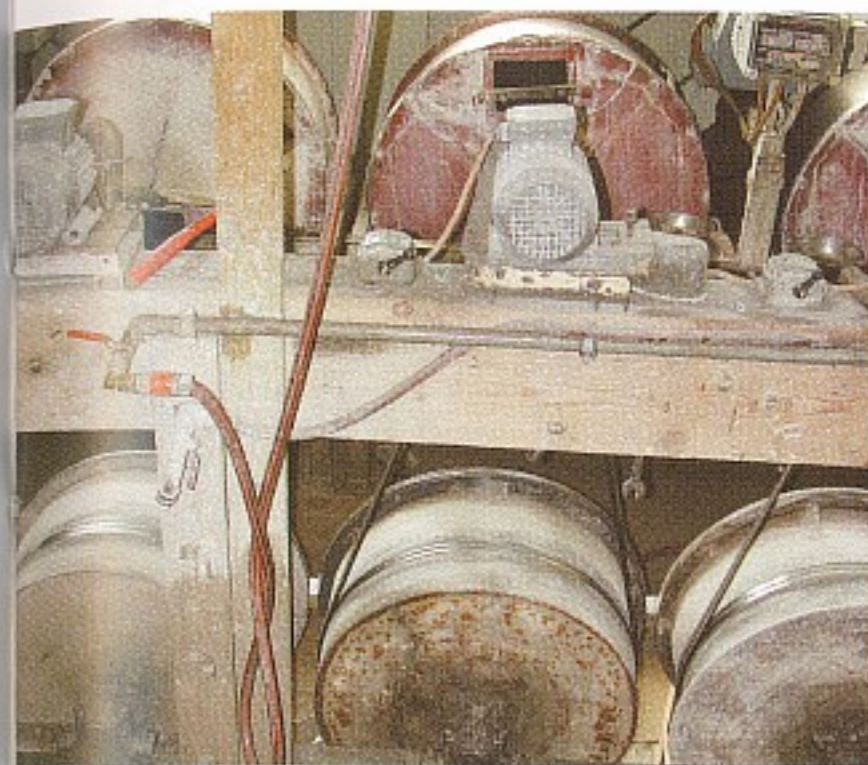
Установки для барабанной шлифовки, слева – со стальными барабанами с горизонтальной осью, справа – с вибрирующими барабанами и вертикальной осью
