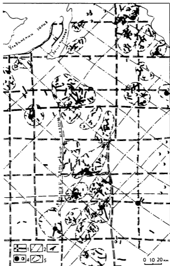
Рис. 50. Рудоограничительная роль межблоковых разломов. Характерный пример - Нижнее Приамурье. 1 - междолевые субмеридиональные разломы; 2 - секущие рудолокализирующие разломы; 3 - золотоносные россыпи; 4 - месторождения и рудопроявления золота; 5 - контуры золотоносных узлов.
