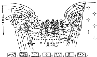
Рис. 25. Обобщенная модель формирования золотоносных зеленокаменных поясов, содержащих метаморфогенно-гидротермальное оруденение. 1 - в различной мере метаморфизованные вулканогенные и (или) вулканогенно-осадочные образования; 2 - метаморфогенные мигматиты, палингенно-метасоматические граниты; 3 - кристаллический фундамент (AR - PR 2 ); 4 - постметаморфические (пострудные) интрузивные граниты (крупные массивы); 5 - разрывы: а - типа межблоковых глубинных разломов, б - рудолокализирующие зоны повышенной проницаемости; 6 - пострудные магматические породы различного состава, преимущественно в виде небольших массивов и джек; 7 - пути миграции растворов: а - метаморфогенно-гидротермальных, б - метаморфизирующих глубинных
