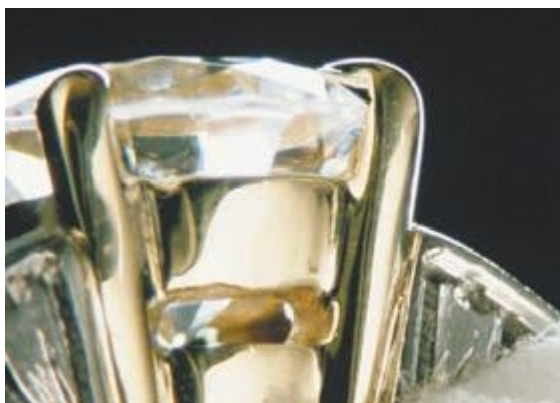
Рис. 8.4 Плохо вставленный камень. Обратите внимание на пространство между камнем и крапаном справа.
