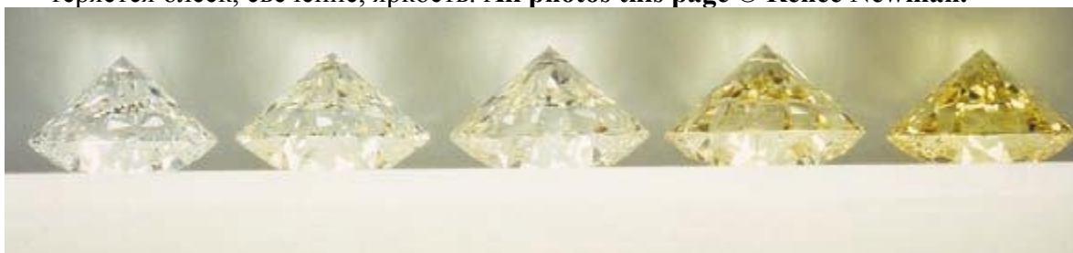
Рис. 5.6 Тонкая корона и глубокий павильон. При взгляде сверху, у бриллианта теряется блеск, свечение, яркость. All photos this page © Renée Newman.
