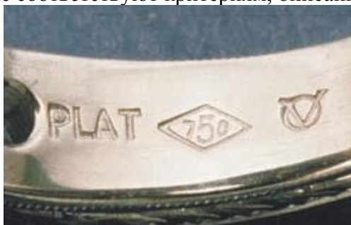
Рис. 7.3 Проба для 95 %-ной платины и 18-каратного (750 проба) золота, рядом с торговым знаком Varna Platinum.
