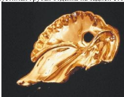
Рис. 8.1 Недопустимая грубая отделка на задней стороне отливой броши.
