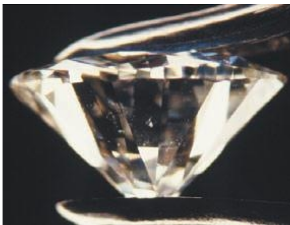
Рис. 5.6 Тонкая корона и глубокий павильон. При взгляде сверху, у бриллианта теряется блеск, свечение, яркость. All photos this page © Renée Newman.
