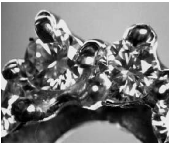
Рис. 8.6 Громоздкие несимметричные крапаны.
