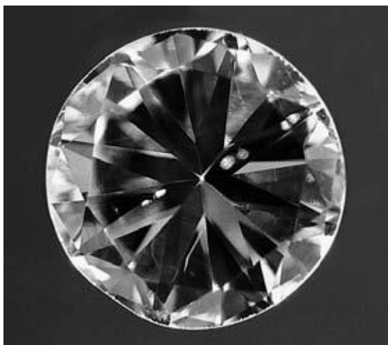
Рис. 5.3 Темный центр, образовавшийся вследствие того, что павильон слишком
