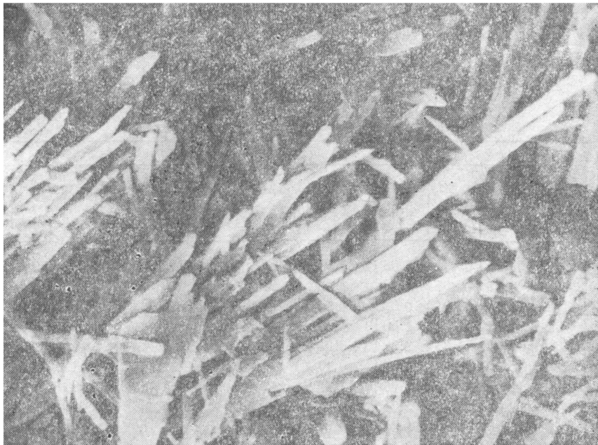
Рис. 40. Электронно-микроскопический снимок апосерпентинитового нефрита. Увел. 2000.
