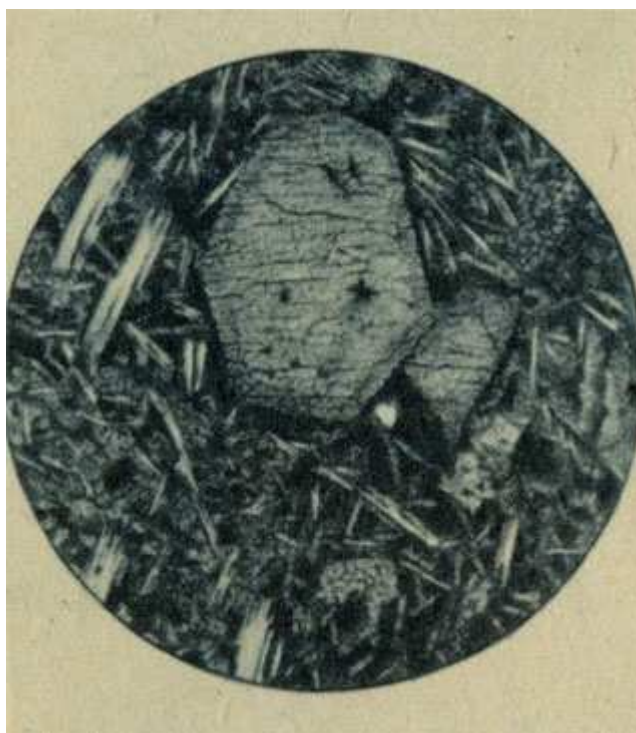
Рис. 17. Шлиф базальта под микроскопом
