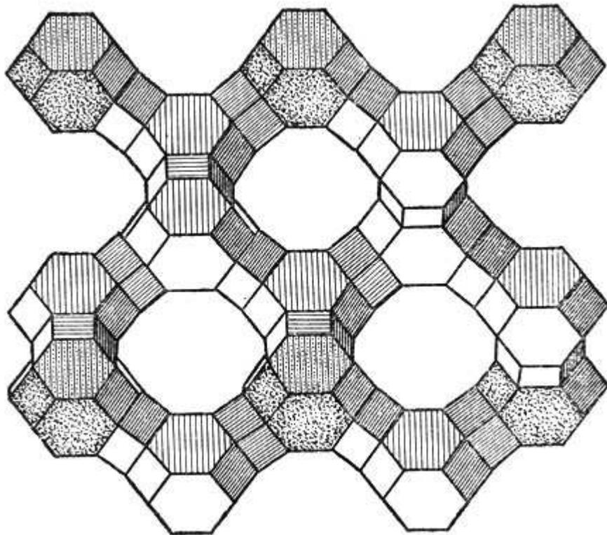
*Рис. 17. Структура цеолита (фюзита). Видны широкие каналы, благодаря которым цеолиты используются в качестве молекулярных сит*
