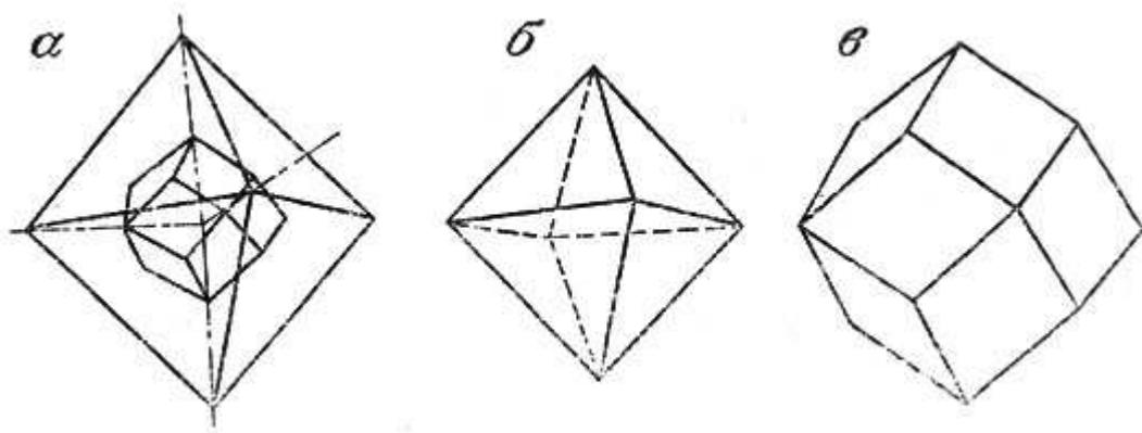
*Рис. 14. Формы граната и гибшита: а - схема параллельного нарастания октаэдра гибшита на ромбический додекаэдр граната; б - обычная форма гибшита - октаэдр; в - обычная форма граната - ромбический додекаэдр*
