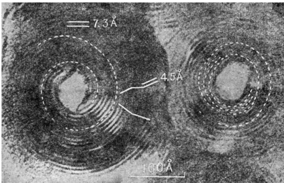
*Рис. 34. Строение хризотил-асбестовых волокон. Хорошо распознается спиральное закручивание волокна. Можно измерить и размеры пакета (из работы японского минералога Яда)*
