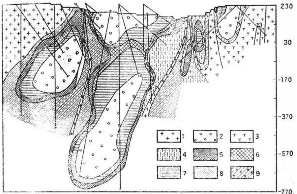
Рис. 25. Схематический разрез центральной части Баженовского месторождения, сто Ф. В. Дыбкову. 1 - граниты, гранит-аплиты, диориты, габбро; 2 - перидотиты; 3 - тальковые, тальк-карбонатные породы; 4 - серпентиниты с просечками асбеста; 5 - то же, с асбестом типа мелкой сетки и мелкопрожила; 6 - то
