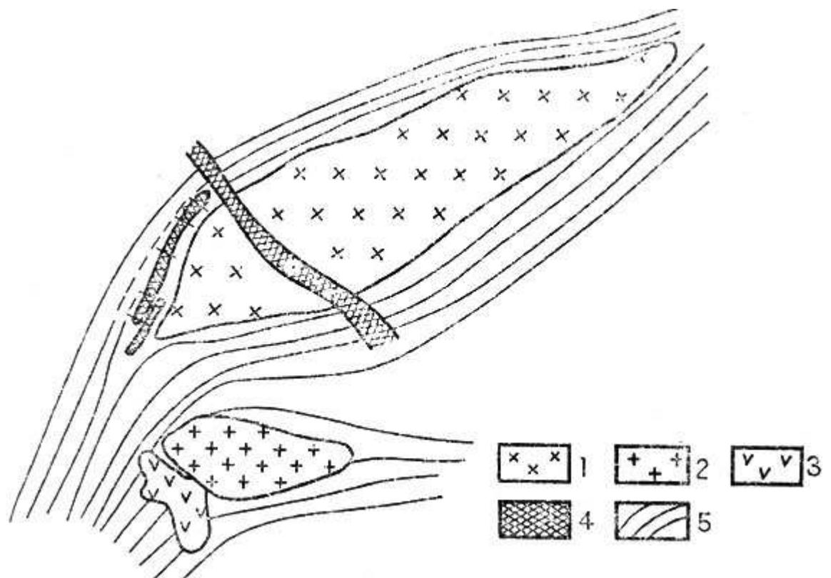
*Рис. 9. Схема распространения магматических пород близ устья р. Уравель. 1 - более молодой поток шаровой лавы; 2 - более древний поток шаровой лавы; 3 - порфирит с глыбовой отдельностью; 4 - тела тешенитов; 5 - туфогенные породы*
