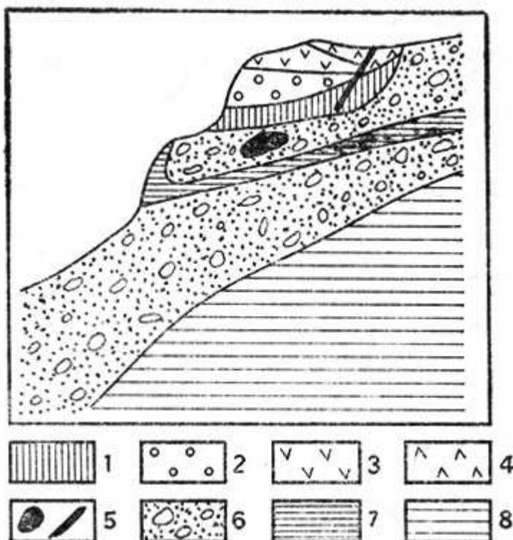
Рис. 7. Геологическая интерпретация фото рис. 6. 1-4 - андезитобазальтовый интрузив (1 - зона со столбчатой отдельностью и жеодами агата, 2 - крупноглыбовая зона с жеодами цеолитов, 3 - мелкоглыбовая зона с мелкими жеодами,
