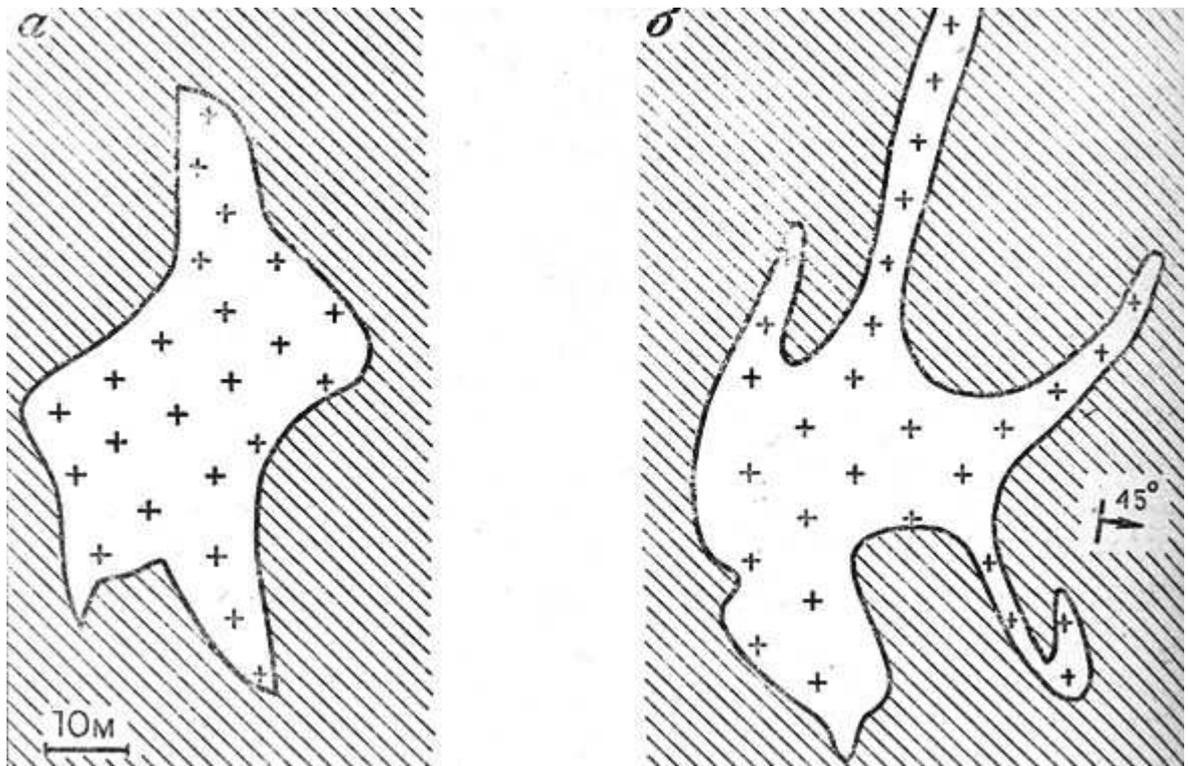
Рис. 47. Сечение паукообразной жилы. а - близ поверхности; б - на глубине 250 м
