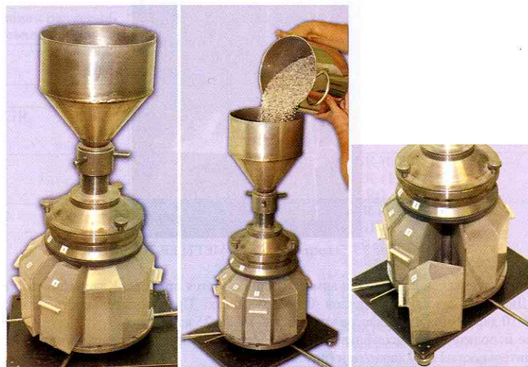
Рис. 3.5. Ротационный конусный делитель
