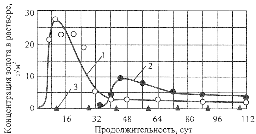
Рис.5.7. Динамика кучного выщелачивания золота из блок-секций окисленной руды опытно-промышленной установки Майского рудника
