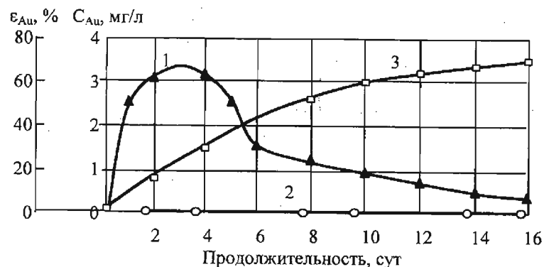
Рис. 2.5. Динамика выщелачивания золота из окомкованных руд золото-сульфидно-кварцевой формации (Светлинское месторождение, смесь руд: 60 % окисленной крупностью дробления 88 % класса -25 мм и 40 % первичной крупностью дробления -5 мм):
